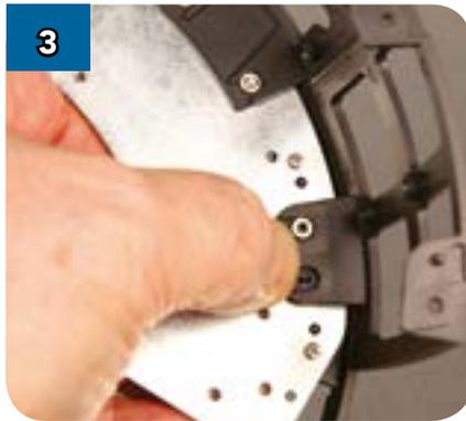
Удерживая раму (DF-21), вставьте гайку в одно из шестиугольных гнезд над крепёжным отверстием.
