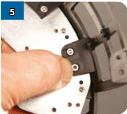
Вставьте следующую гайку в шестиугольное гнездо рамы (DF-21).
